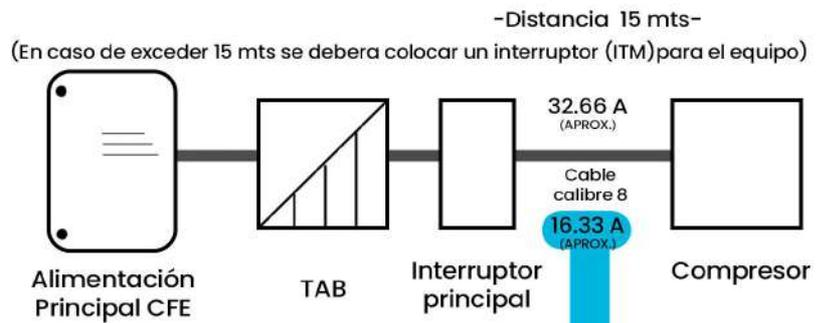
Consumo de amperaje de una línea eléctrica trifásica de 440V a un motor 15Hp MAX SERIES.
